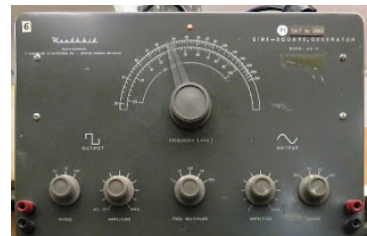
Sinus- och fyrkantsvågsgenerator av märket Heath
