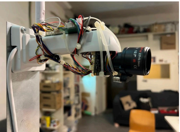
Cámara CCTV en Mini Bobina de Tesla en RTEM#1(red).
